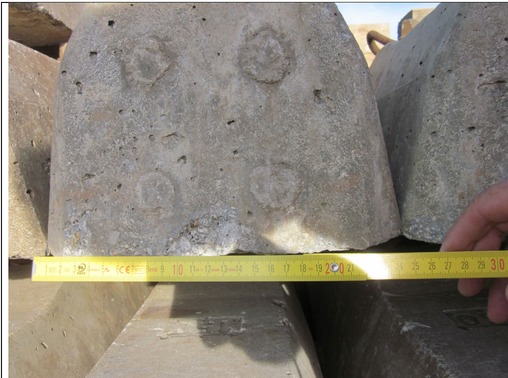
Abbildung 18: Beispiele zu Bereich 3 (Schwellenkopf): Ausbruch an der Sohle. Tiefe geringer als 2 cm und Breite geringer als 6 cm. Somit zulässig.
