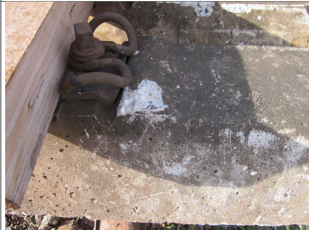
Abbildung 12: Beispiele zu Bereich 1: Abplatzung an der Sickerschulter. Absolut unzulässig und klares Ausschlusskriterium.
