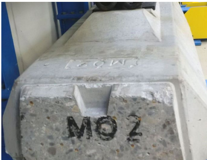
Abbildung 2: Schwelle mit Besohlungsprägung (auf der Oberseite) mit „M02“ für harte Sohle
