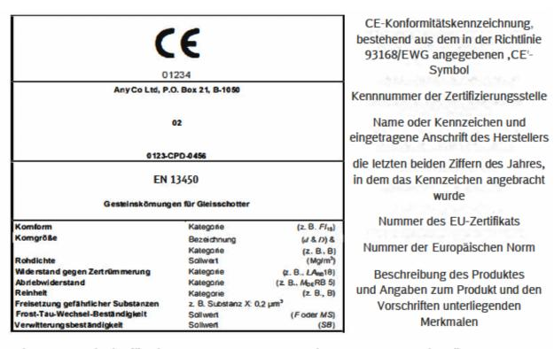
Bild ZA.1 - Beispiel für die Angaben zur CE-Kennzeichnung von Gesteinskörnungen für Gleisschotter nach System 2+
