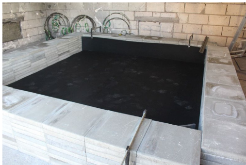
Bild 2: Beispiel Versuchsaufbau USM mit Seitenmatten
