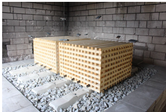
Bild 4: Holzkrippen als Brandlast
