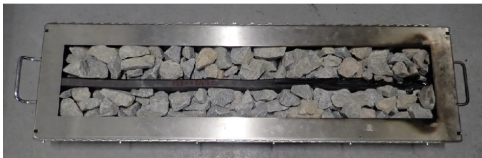
Bild 1: Beispiel für den Probekörper einer USM
