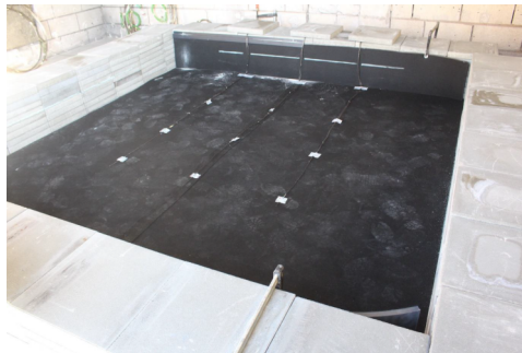
Bild 5: Thermoelemente auf USM
